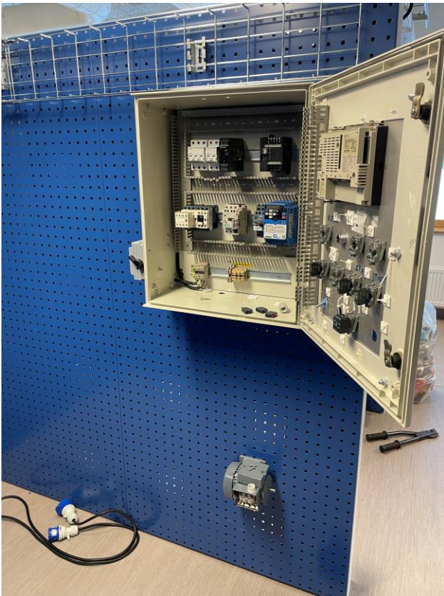
Figur 1_modelrigg for frekvensstyrt motor
